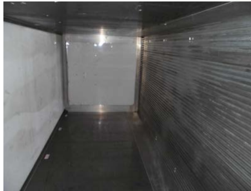
コンテナ内はアルミ張り
