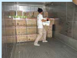
コンテナ内はアルミ張り
