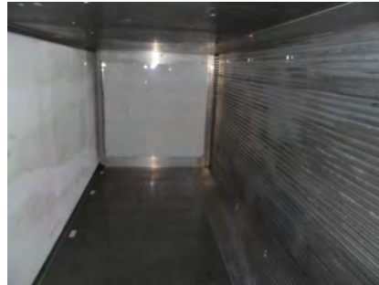
コンテナ内はアルミ張り
